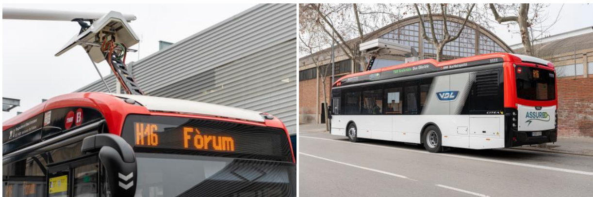
Carga por pantógrafa de un autobús de pruebas en la cochera y en la parada de la línea H16
