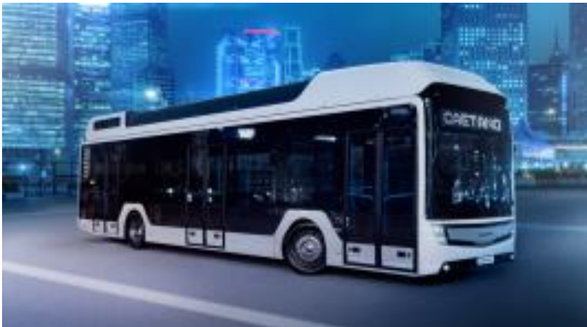
El modelo H2 City Gold de Caetano, propulsado por pila de hidrógeno
